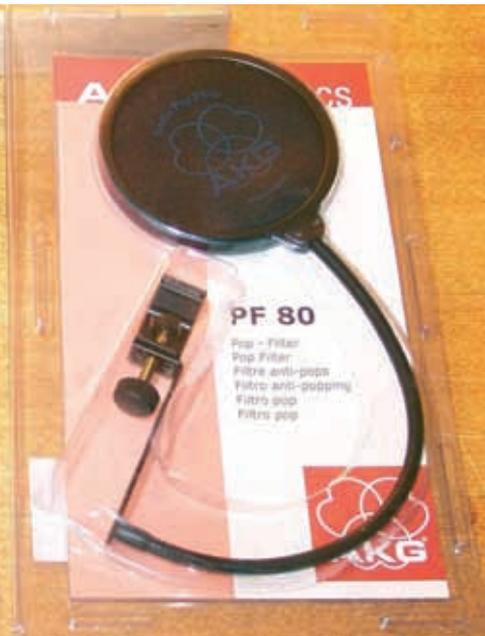
des Luftstroms um 35° nach unten und damit an der Mikrofonkapsel vorbei. Dadurch werden Störgeräusche verhindert, die vor allem bei Verschlusslauten wie »P« und »B« entstehen. Dies geschieht, ohne Frequenzen auszufiltern, somit bleibt die Aufnahme selbst unangetastet.“
