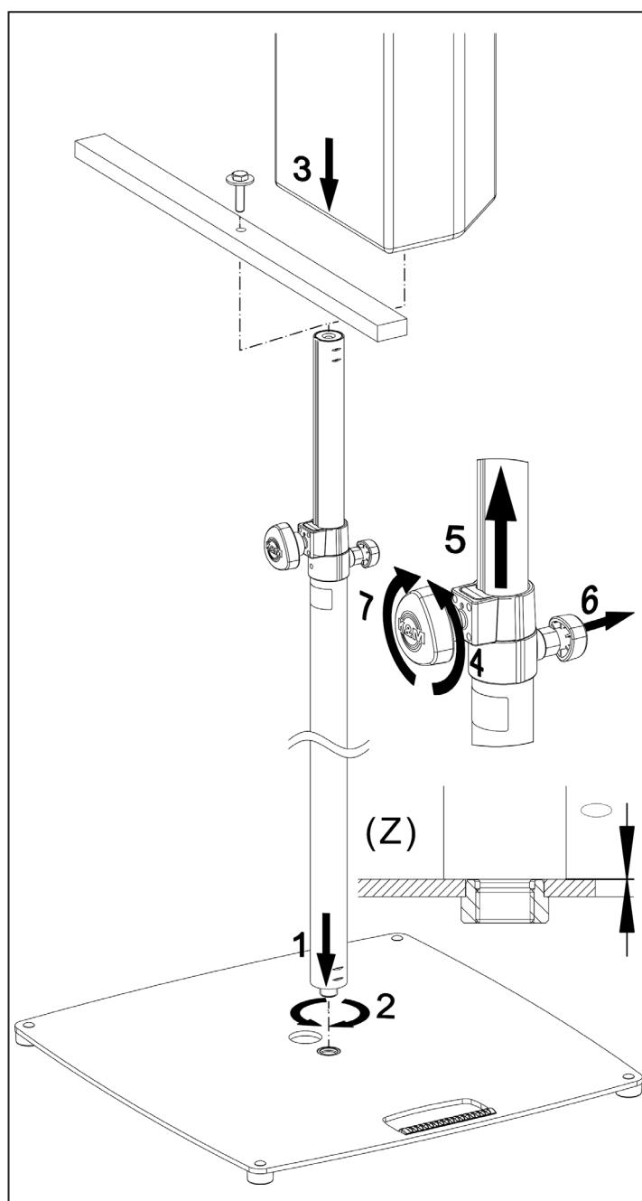
Die Klemmschraube muss vor der ersten Verwendung einmalig in die Spannschelle eingeschraubt werden.
