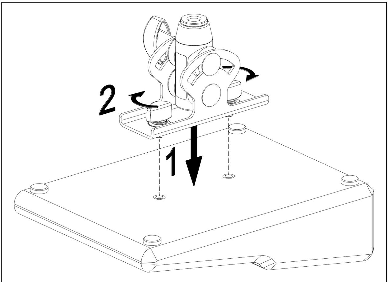
Equipment so ablegen, dass die Aufnahmegewinde nach oben zeigen. Stativadapter ansetzen **1** und mit den Klemmschrauben handfest anziehen **2**.
