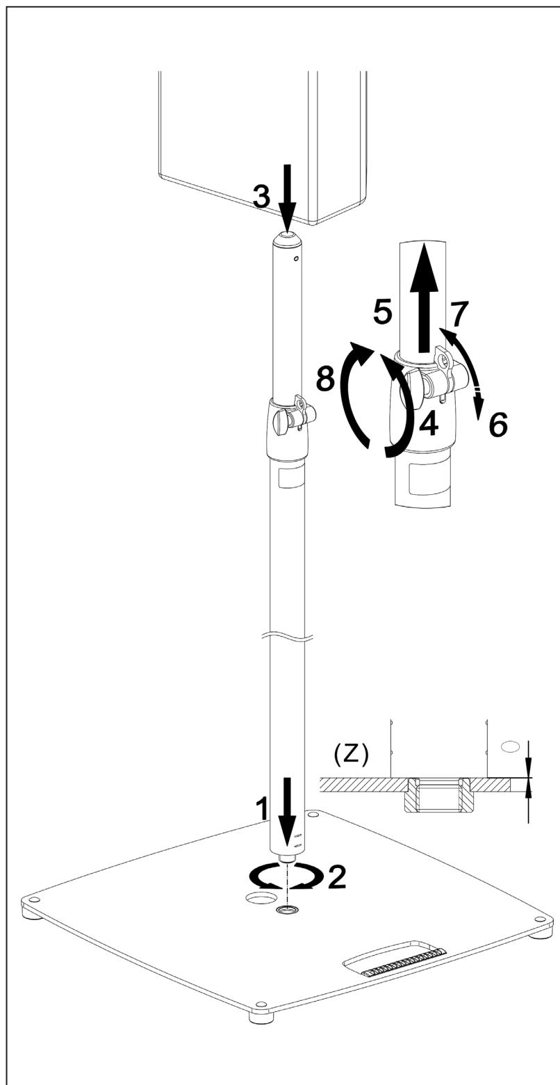
2.) Rohrkombination auf Sockel montieren
