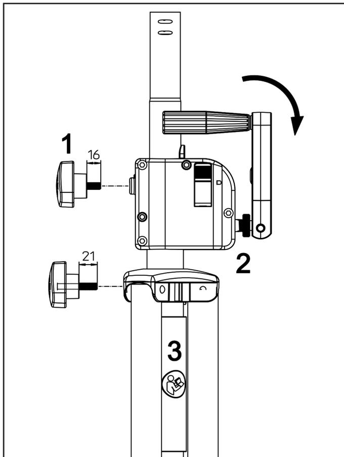
Die Klemmschrauben **1** müssen vor der ersten Verwendung einmalig in das Kurbelgehäuse (M8 x 16 mm) und die Fußschelle (M8 x 21 mm) eingeschraubt werden.
